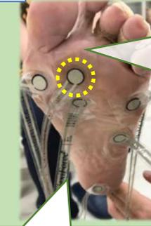
感圧センサーを足底に固定。自社製計測機器を用いて、歩行中のリアルタイム計測を行う。
